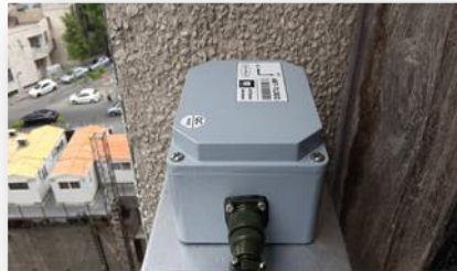
شکل ۳: نمونه ای از شیبسنج های به کار رفته در این پژوهش
