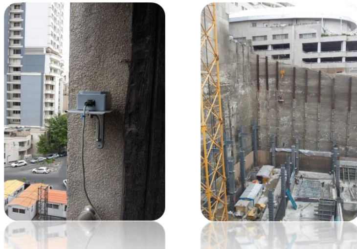
شکل ۴: نمایی از محل های نصب دو شیبسنج به کار رفته در این پژوهش
